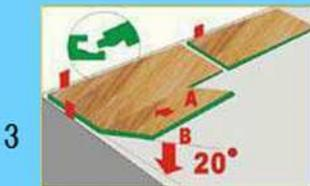
3 Монтировать панели с замком, под углом, сдвигая панель на половину длины.
