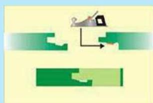
B. Схема конструкции гребень-паз. (подрезать замок и монтировать панель без замка)
