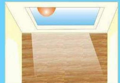
Установить панели пола параллельно основному направлению света
