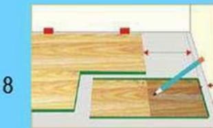
8 Для завершения ряда повернуть панель на 180° и отметить линию отреза.
