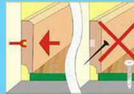
14 Настил пола производить «плавающим способом», не использовать гвозди, саморезы и клей.
