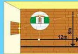
15 Зазоры линейного расширения, при настиле больших помещений.
