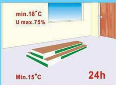
Обеспечьте хранение ПВХ пола в горизонтальном положении, в упаковке, в течение 24-х часов
