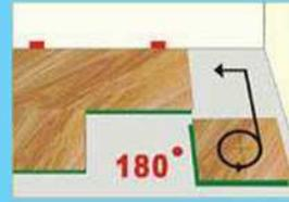
9 Отрезать последнюю панель, повернуть на 180° и установить.
