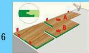
6 Соединить поперечные стыки панелей
