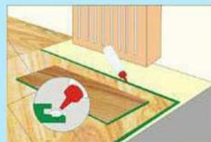
C. Использовать клей для соединения места стыка (шва)
