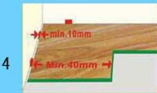
4 При укладке необходимо соблюдать соответствующий зазор между полом и стеной и/или другим полом.
